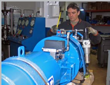
Vicente Brunet, montando un actuador neumático para válvulas de control de mariposa de MANCHASOL 1
