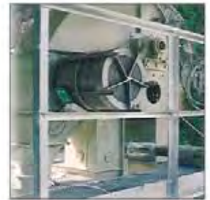
Cabeza de elevador asegurada mediante un Q-Rohr®-3
