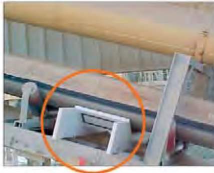
Detector de metal debajo de una cinta transportadora
