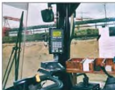
LOADRITE® incluyendo impresora y sistema de adquisición de datos
