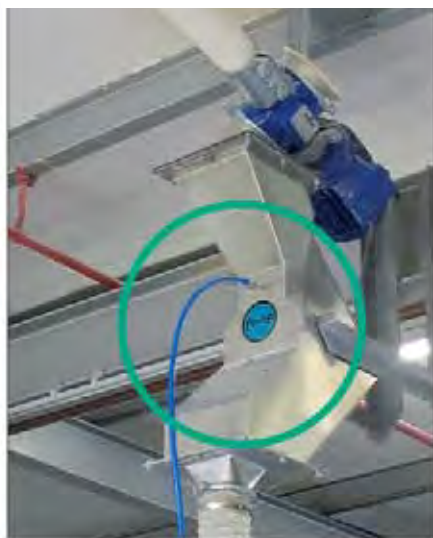
Medición de caudal de tiza con C-LEVER® II
