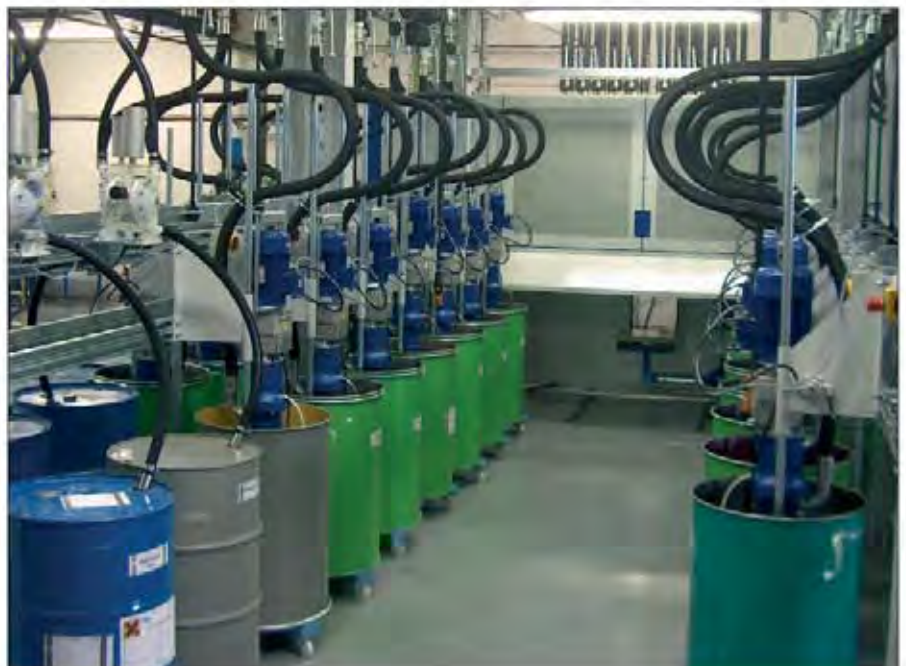
Vaciado económico de barriles con sistema de bombeo REMBE®
