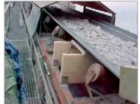
Detector de metal debajo de una cinta transportadora
