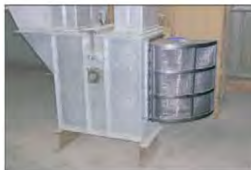
Q-Box protegiendo el pie de un elevador de cangilones
