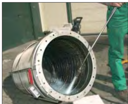
Fácil limpieza del Q-Rohr® después de una explosión
