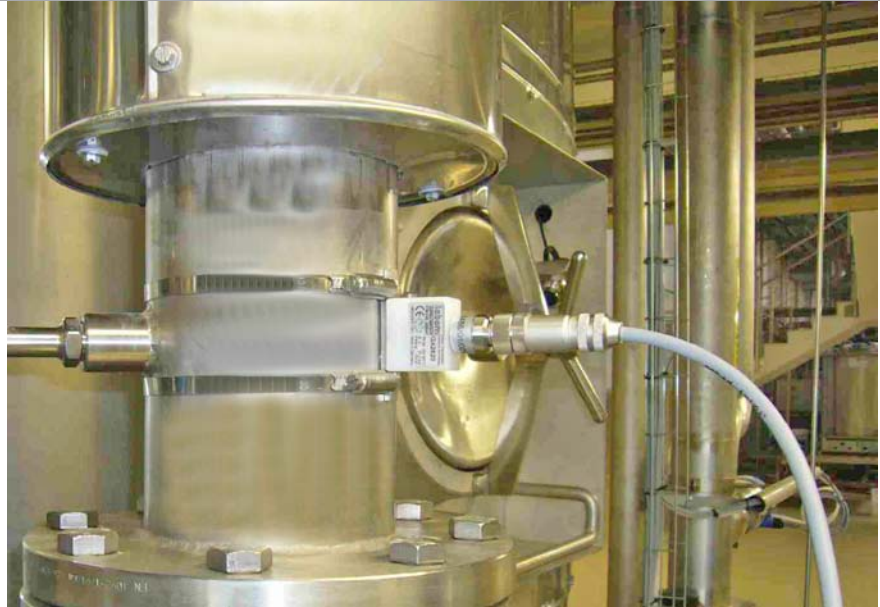
El termómetro de resistencia Labom con tecnología clamp-on – la alternativa a la medición de temperatura convencional invasiva en tubería
